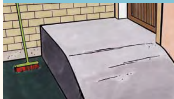
Rampe, der gør det muligt at køre med varerne på trods af niveauforskel
